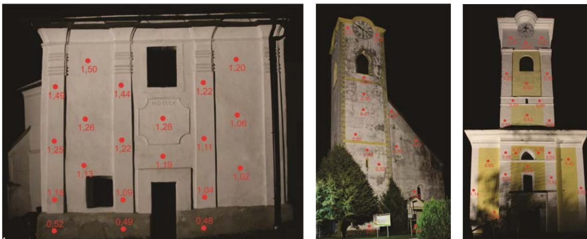
Slika 6: : Rezultati meritev svetlosti fasade z merilnikom svetlosti,
